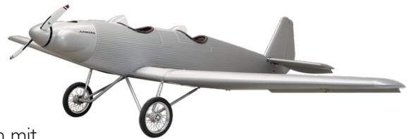
Auch hier wird wieder historisches Flair mit neuester Technik vereint. Die Serienmäßige Ausstattung mit einem Rotax 912iS / 4 Zyl Einspritzer Motor, 2 Blatt MT Propeller (3 Blatt optional), Beringer Bremsen, GARMIN Avionik (G3X) und einem Galaxy Rettungsgerät ermöglichen Flüge mit höchstem Sicherheitsstandard.
